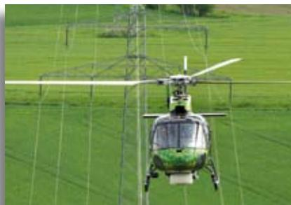
ALS-System TopEye. Helikopter mit einem komplexen System zur dreidimensionalen Erfassung von Daten.
