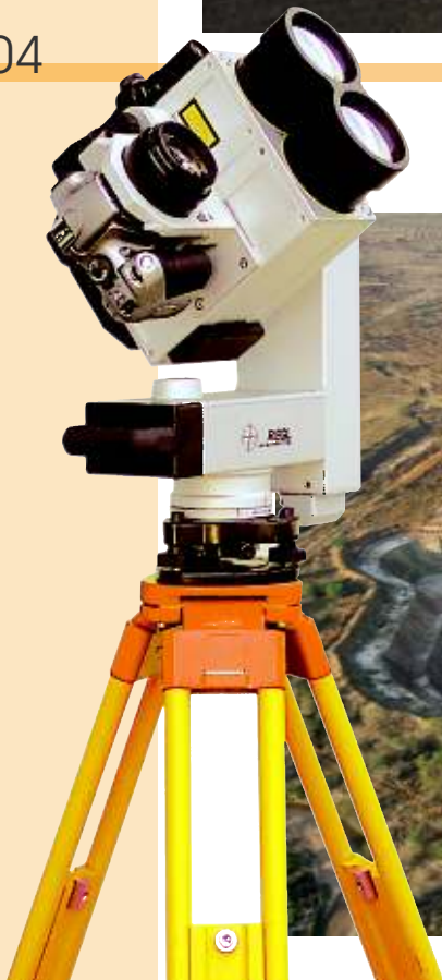
LPM-i800HA Hochgenaues Profilmessgerät für große Entfernungen
