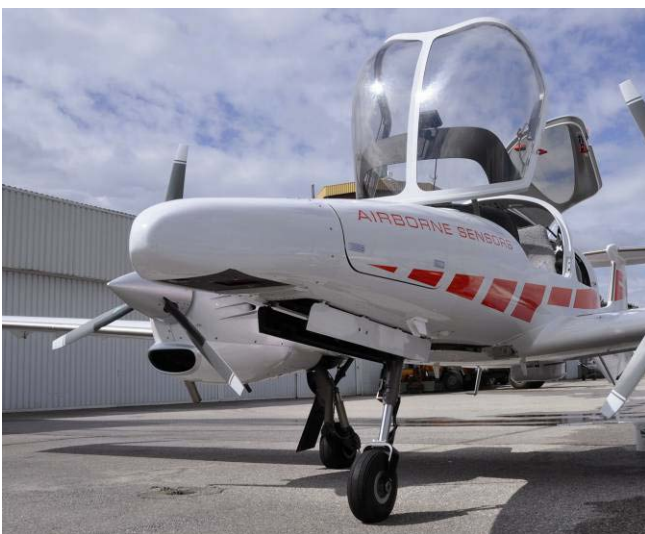
RIEGL NP680i: Der Nose-Pod beinhaltet die komplette Hochleistungstechnik
