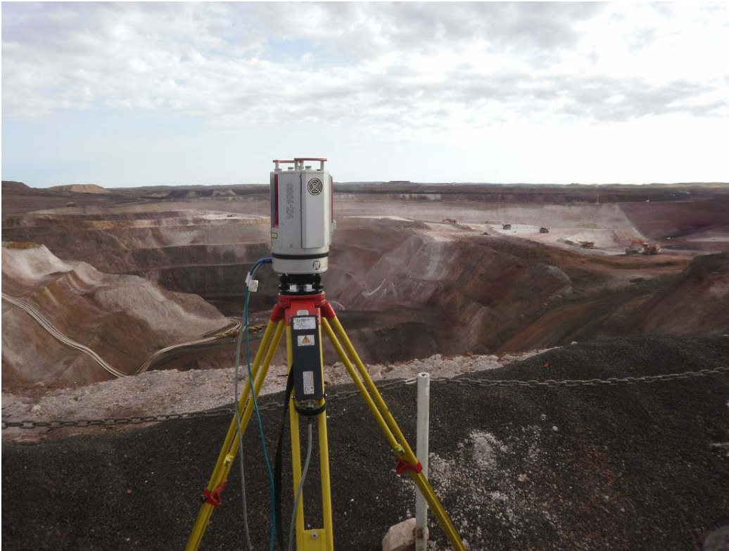
Im australischen Tagebau: der RIEGL VZ-1000 übertrifft alle Erwartungen
