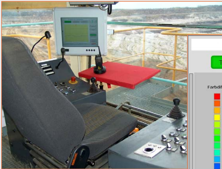
Visualisierung der Messwerte für den Gerätefahrer
