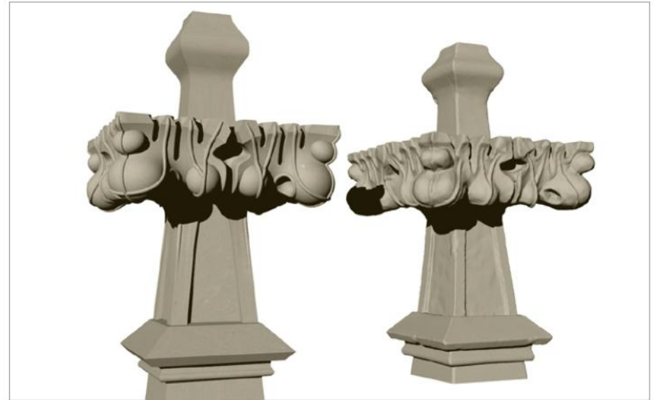
Bild 3: Links: Parametrische Rekonstruktion einer Kreuzblume von St. Matthias Berlin (Prof. Daniel Lordick) / Rechts: Punktwolke und Mesh (Scan3D GmbH)
